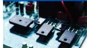
室外機のインバータ回路に採用。ふたつのPAM回路により、大出力から小出力まで高効率を達成。
